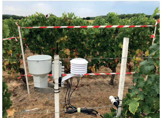
Dispositif de mesure de la température du feuillage par infrarouge et de la température ambiante. 2020, secteur de chinon.
