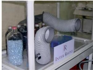
La BOXYGÈNE d'Inter Rhône - enceinte isolée pour la manipulation des échantillons à l'abri de l'air.
