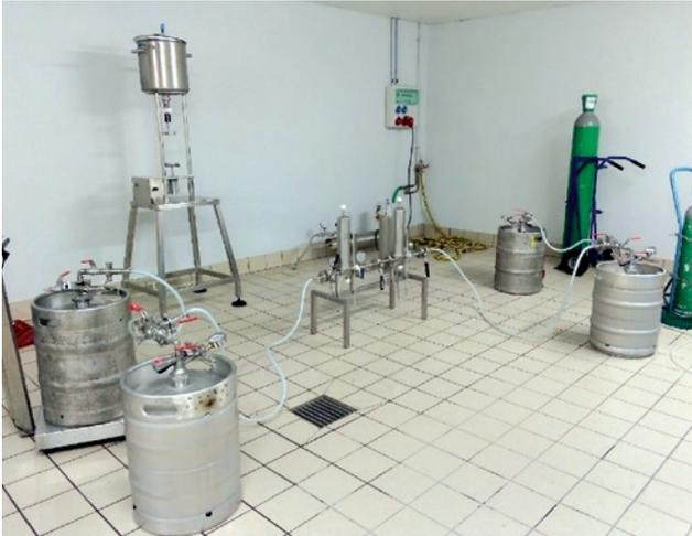
**FIGURE 1 : Filtration des vins après prise de mousse - IFV Pôle Val de Loire Centre**
