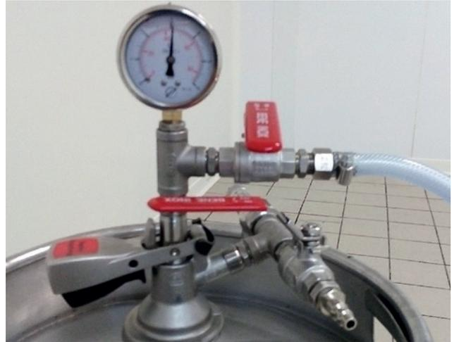
**FIGURE 2 : Minicuve isobarométrique - IFV Pôle Val de Loire Centre**
