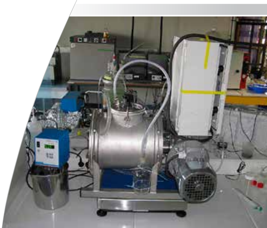
Réacteur de codigestion utilisé à l'échelle laboratoire
