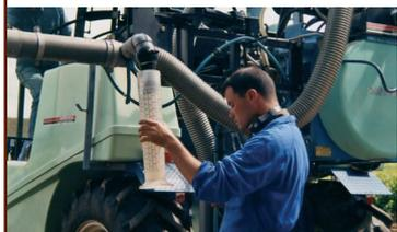
Utilisez une éprouvette graduée et quantifier le volume d'eau écoulé sur 2 ou 3 buses différentes ou diffuseurs pour les appareils pneumatiques pendant un temps donné (1 mn suffit) à la pression choisie.
