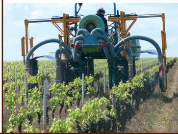
Adaptez, dans la vigne, le réglage au gabarit de la végétation (fermeture des buses en bas ou en haut). Soignez l'inclinaison des buses et la hauteur des diffuseurs. Ainsi vous limiterez les pertes inutiles dans l'environnement !
