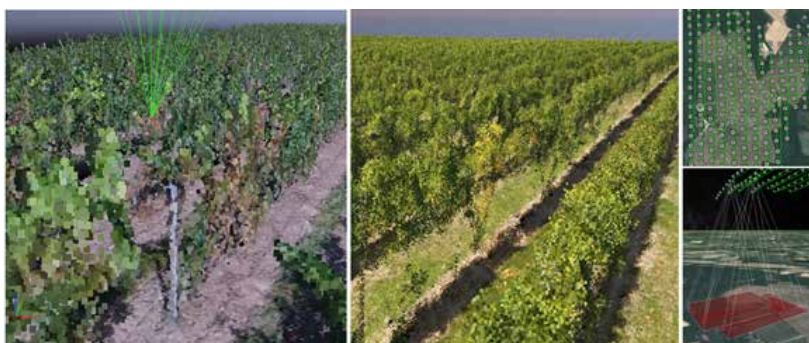
Figure 3 : Nuage de points (3D) colorisé reconstruit à partir des images drone. Résolution du pixel : 0.8 cm.
