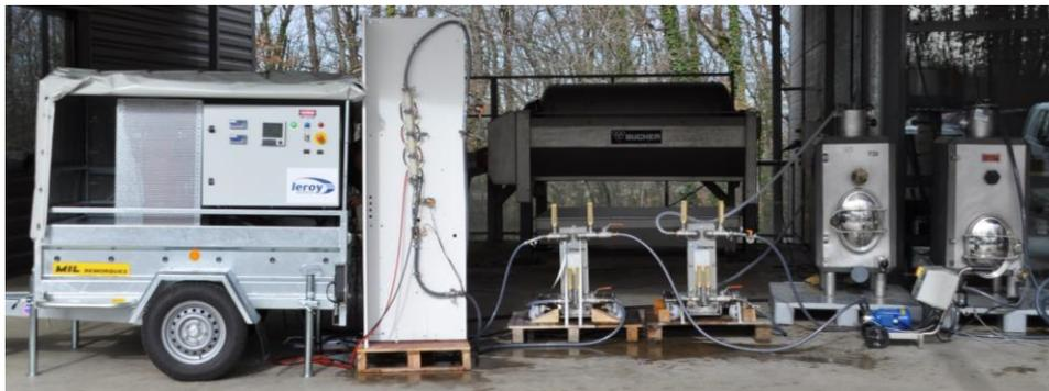
Le générateur de CEP est dimensionné pour un traitement d'environ 4000 l/h. Les chambres de traitements permettent un débit maximal de 1 200 l/h. L'augmentation du débit, se fait par la mise en parallèle des groupes de chambres de traitement sur le même générateur.
