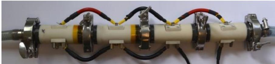
Le suivi des essais se fait par enregistrement de la température avant et après passage dans les 4 chambres et de la consommation électrique.
