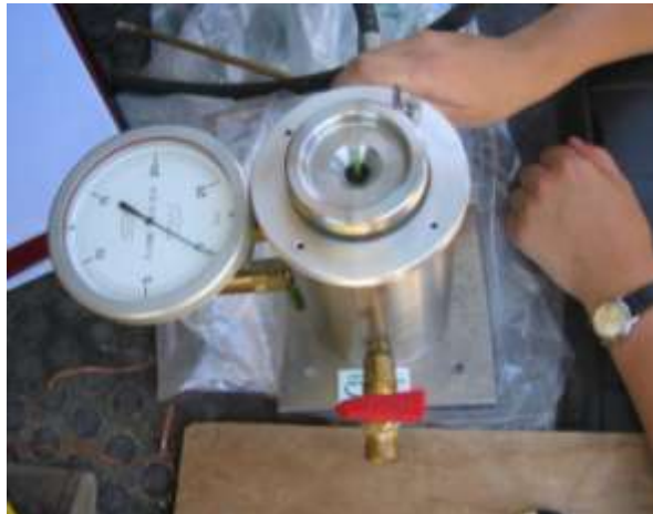
Mesures de \psi_{fb} (potentiel foliaire de base) à la chambre à pression
